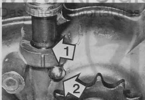
Neue Kupplungswelle in das Gehäuse einführen. Hebel befestigen. Markierungen auf dem Gehäuse, der Welle und die gedachte Mittellinie des Hebels müssen genau fluchten. Kernnagel (Pfeil 2) eintreiben. Dichtscheibe beachten.
